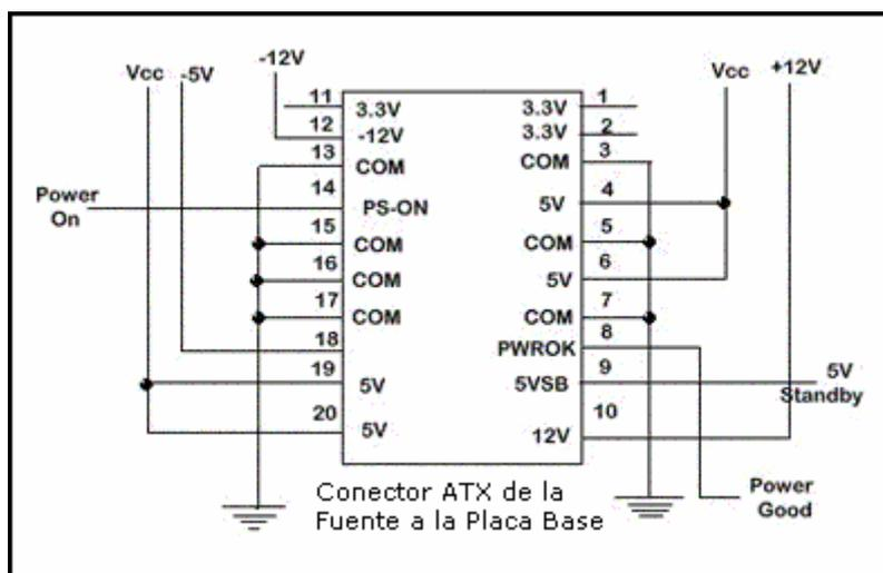
**NOTA:** Las nuevas F.A. de **400w.** y **450w.** vienen con 2 conectores para la placa base, uno grande de **24 hilos** y otro pequeño de 4 hilos. El grande está configurado prácticamente igual que si tuviera los 20 hilos de siempre y el pequeño tiene 2 negros y 2 amarillos (es decir 12v. y 12v.)
